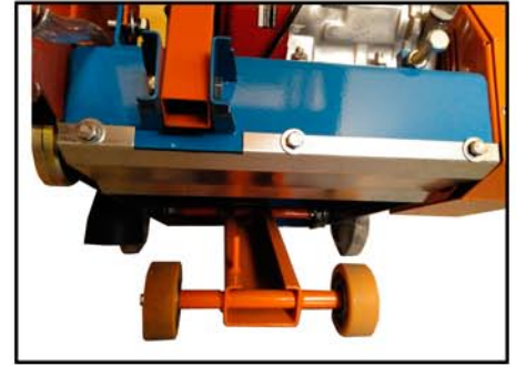
Protección inferior de eje y rodamientos. Axle and bearing below protection.
