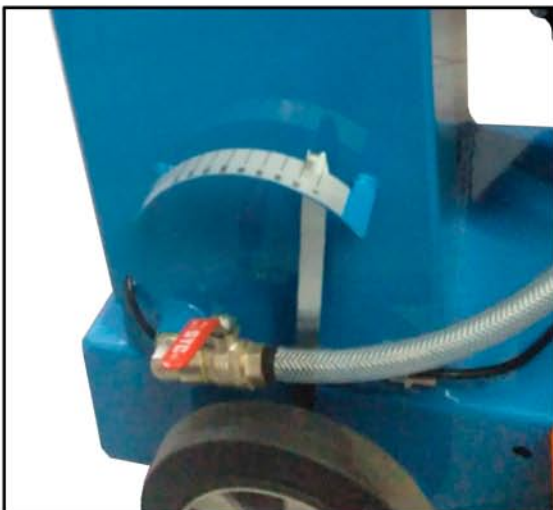
Indicador de profundidad. Cutting depth indicator.
