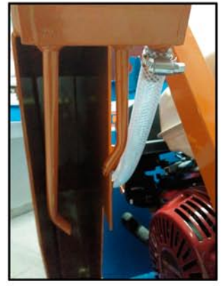
Refrigeración a dos caras. Two sides disc refrigeration.
